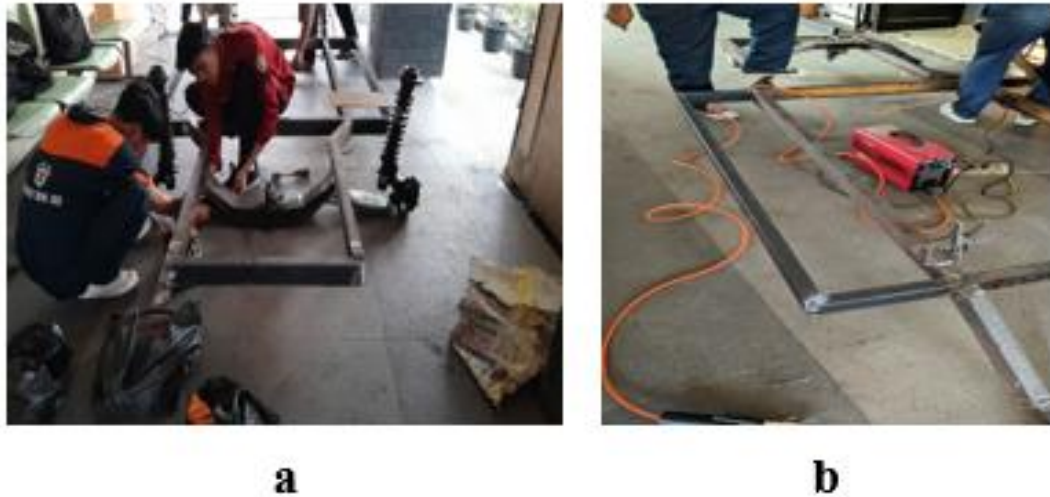
Gambar 2. Proses fabrikasi rangka baja: (a) perakitan/ fit-up rangka, (b) pengelasan SMAW/MMA
