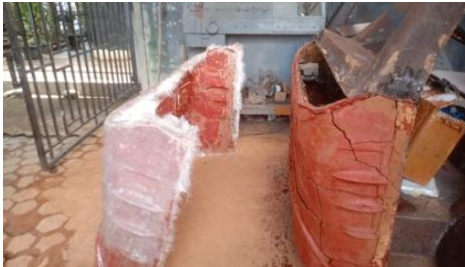
Gambar 3. Panel bodi fiberglass hasil pelepasan cetakan setelah proses hand lay-up dan curing
