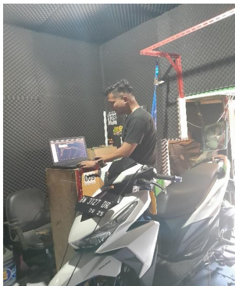
Gambar 2. Pengambilan Data dengan Dynotest
