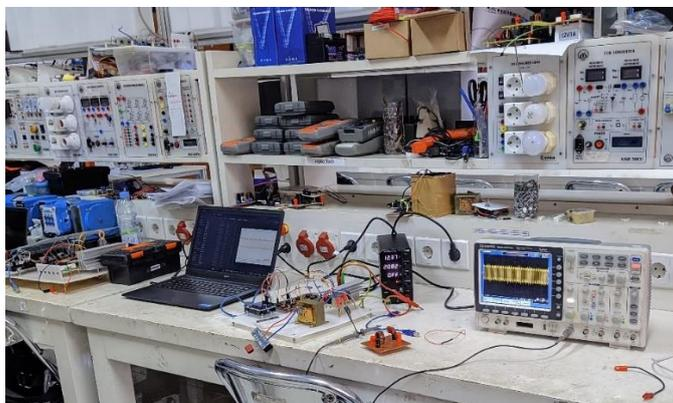
Gambar 2. Proses Pengujian Inverter
